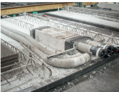
Das Rohbauset wird werkseitig in die Fertigwand integriert
